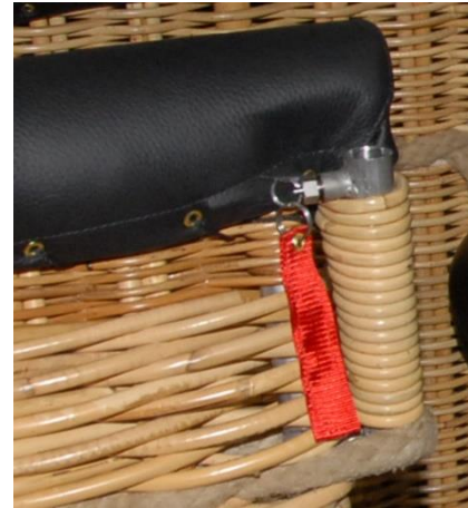
Bild 6: Arretierbolzen der Tür
