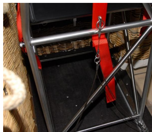
Bild 2: Deaktivierung der Sicherungsbolzen
