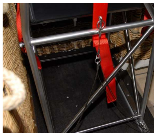
Image 2: Désactivation des boulons de sécurité
