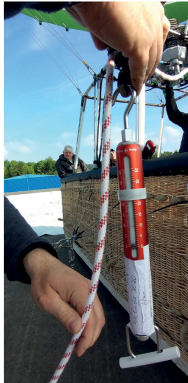
Messung der Bedienkräfte der Betätigungsleinen.
