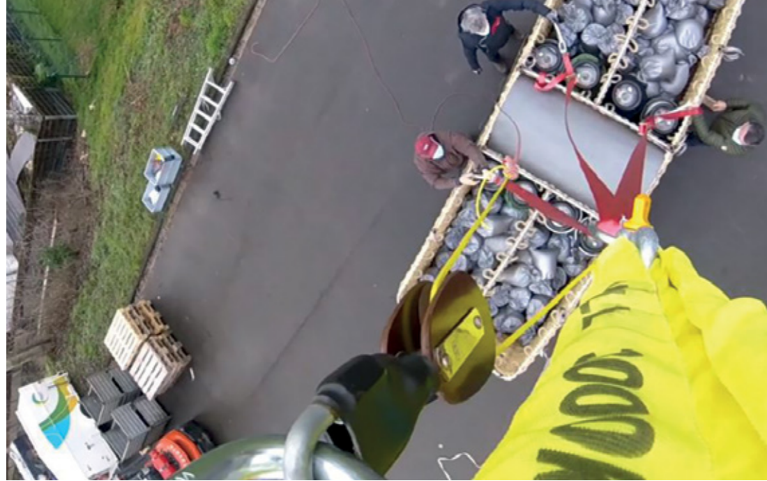
Für die Fallversuche wurde der Korb mit 3.200 kg beladen und angehoben.
